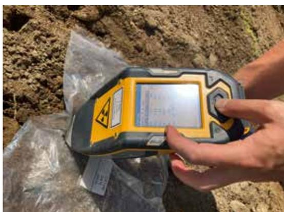
Messgerät der Geologin zeigt Bleigehalt im Boden
